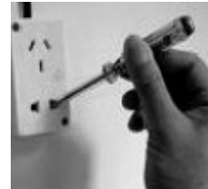
D. 使用测电笔时手不接触笔尾金属体
