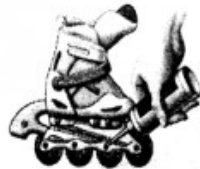
(c) 给轮滑鞋的转轴表面加润滑剂
