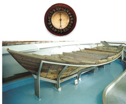
配置水密隔舱和罗盘的宋代海船
