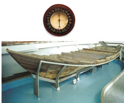
配置水密隔舱和罗盘的宋代海船
